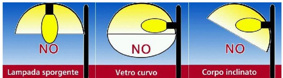
*Apparecchi non conformi per configurazione alla Lr 17/2009*
