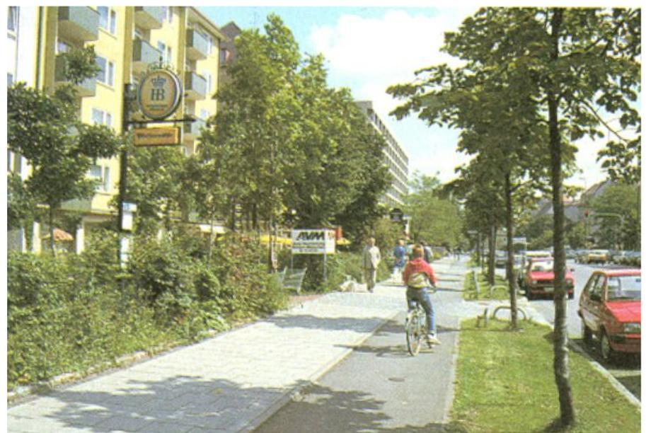
*Realizzazione di separatori di traffico mediante l'utilizzo di elementi arborei e individuazione dei percorsi carrabili, ciclabili e pedonali mediante diversificazione della pavimentazione*
