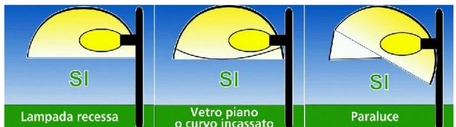
*Apparecchi conformi per configurazione alla Lr 17/2009*
